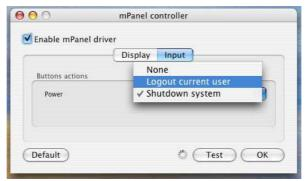
mPanel è anche fornito di vari pulsanti, questi possono essere configurati nella secona parte del centro di controllo, ad esempio possiamo scegliere quale azione intraprendere nel caso incui si attivi un determinato pulsante.
